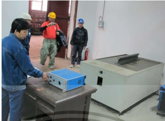
รูปที่ 2.15 การนำหน้าหนักแท้จริงของรางโดยการชั่งน้ำหนักขึ้นราง [45]
