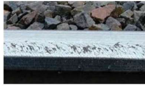
การแตกเป็นเส้นที่หัวราง (Head Checking with Spalling)
