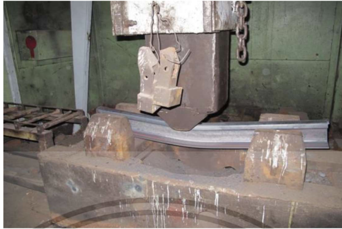
รูปที่ 2.6 ชิ้นรางที่ผ่านการรับน้ำหนักตกกระแทก [45]
