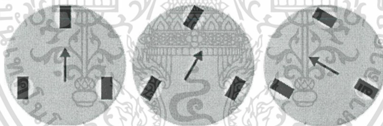
รูปที่ 2.5 การเคลื่อนที่แบบ Synchro Drive [14]
