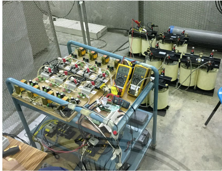
รูปที่ 4.3 โครงสร้างเพาเวอร์คอนเวอร์เตอร์ที่จัดสร้างขึ้น
