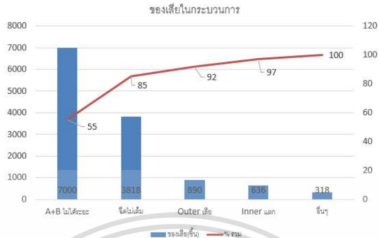
รูปที่ 3.7 ของเสียที่เกิดขึ้นในกระบวนการย้อนหลัง
