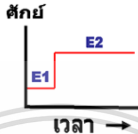
รูปที่ 2.12 กราฟแสดงความสัมพันธ์ระหว่างศักย์ไฟฟ้ากับเวลาของเทคนิคแอมเพอโรเมทรี [30]
