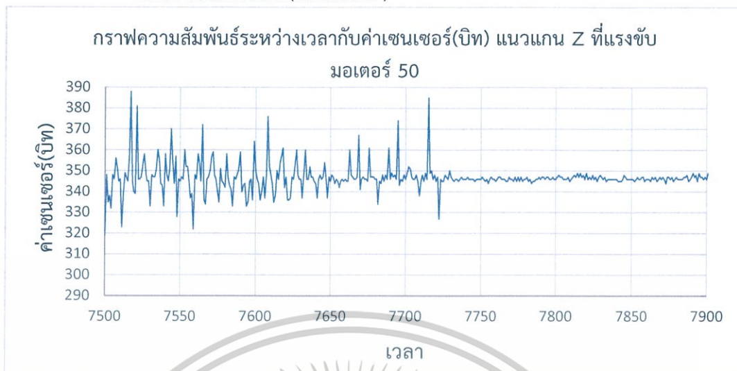
รูปที่ 4.10 ลักษณะเซนเซอร์ที่ใช้วัดแรงการสันสะเทือนก่อนการสัน (แนวแกน Z)
