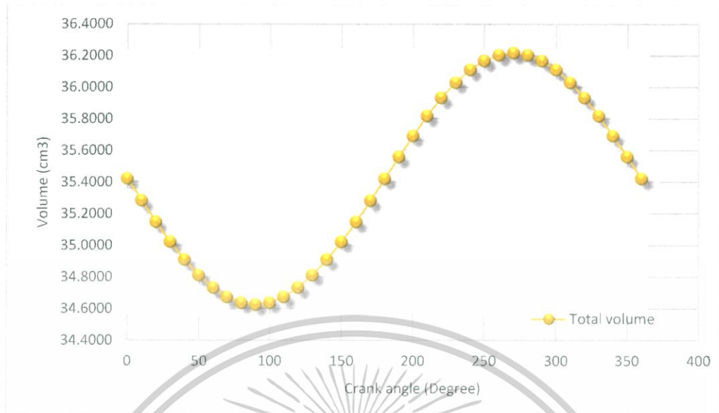
รูปที่ 4.4 กราฟความสัมพันธ์ระหว่างปริมาตรรวมกับมุมข้อเหวี่ยงของเครื่องยนต์
