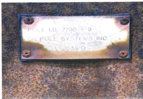
รูปที่ 2.3 ตัวอย่างการกัดกร่อนแบบกัลวานิกโดยการยึดติดแผ่นเหล็กกล้าไร้สนิมกับเหล็กกล้าคาร์บอน [7]
