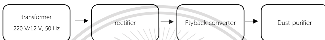
รูปที่ 2.9 บล็อกไดอะแกรมของแหล่งจ่ายไฟฟ้าแรงดันสูงแบบสวิตชิ่งในเครื่องกรองฝุ่นด้วยหลักการทางไฟฟ้าสถิต
