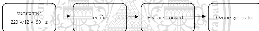
รูปที่ 2.10 บล็อกไดอะแกรมของแหล่งจ่ายไฟฟ้าแรงดันสูงแบบสวิตชิ่งในการผลิตก๊าซโอโซน
