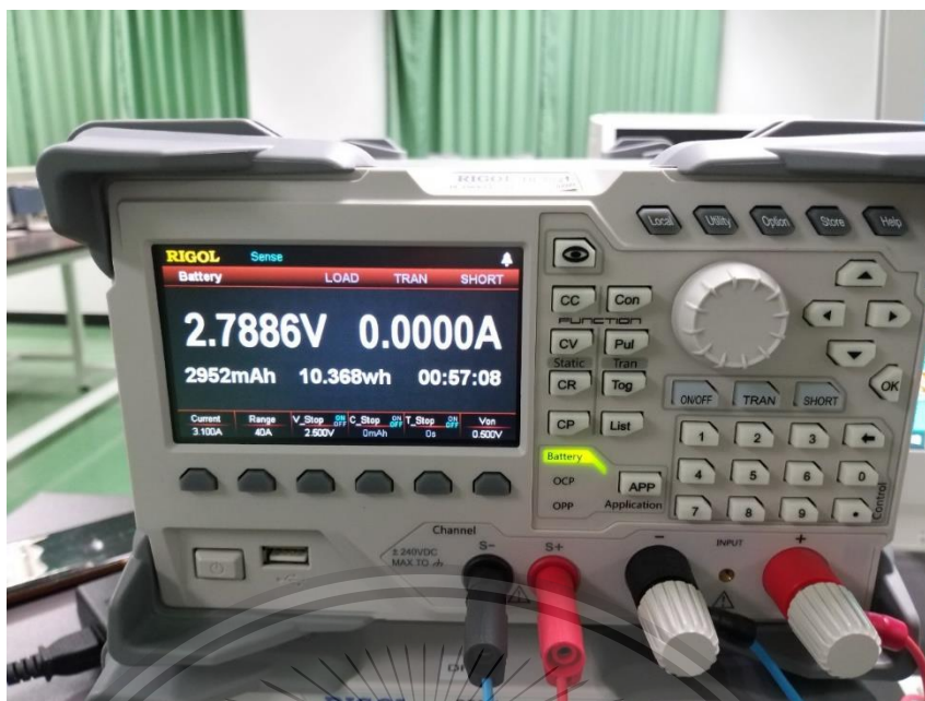
รูปที่ 3.4 ฟังก์ชัน Battery test ใน DL3021
