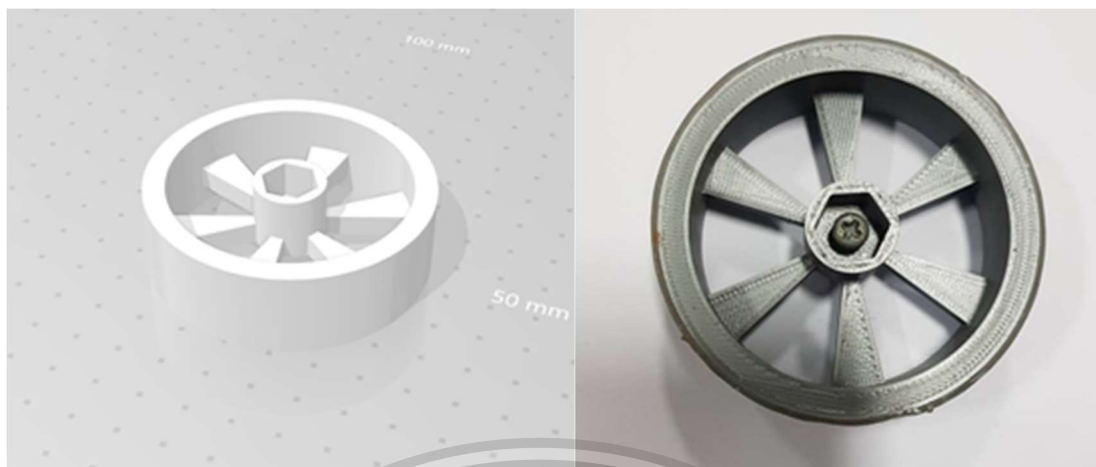
รูปที่ 3.6 โมเดลสามมิติของล้อรถเส้นผ่านศูนย์กลาง 6.5 เซนติเมตร
