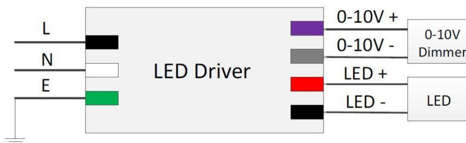
รูปที่ 2.5 ตัวขับหลอดแอลอีดีแบบหรี่ไฟแรงดันไฟฟ้าต่ำ 0-10V
