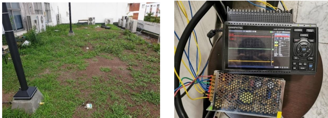
รูปที่ 4.14 การวัดค่าความเข้มแสงบนพื้นที่ใช้งานด้วย Graphtec
