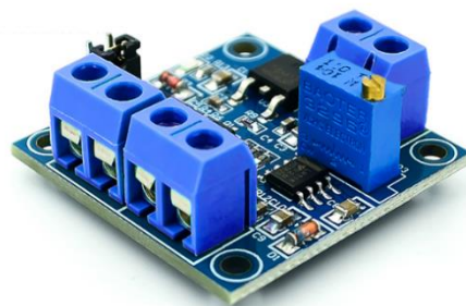
รูปที่ 2.17(ข) PWM to analog 0-10V module
