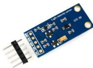
รูปที่ 2.10 เซนเซอร์วัดความเข้มแสง BH1750 GY-30
