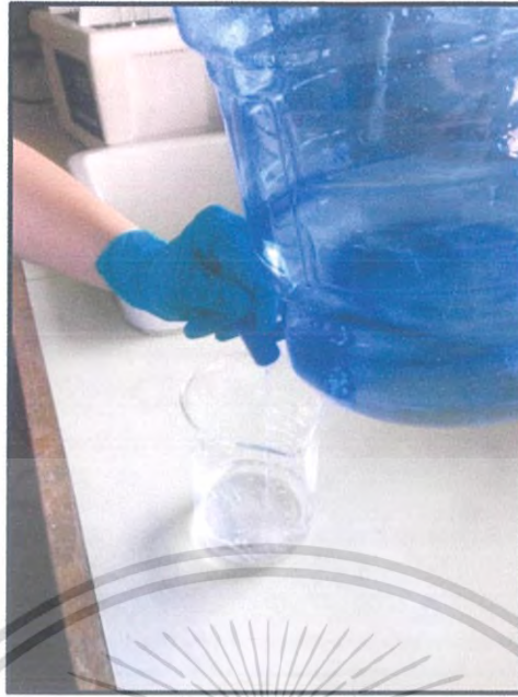
รูปที่ 3.17 ล้างด้วยน้ำปลอดประจุ (DI) ทำความสะอาดด้วยเครื่องอัลตราโซนิกเป็นเวลา 15 นาที
