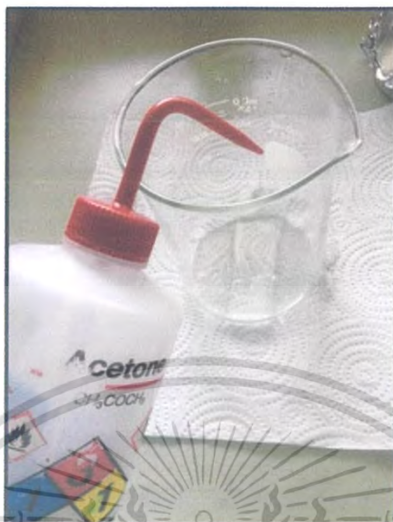
รูปที่ 3.15 ล้างด้วยอะซีโตนทำความสะอาดด้วยเครื่องอัลตราโซนิกเป็นเวลา 15 นาที
