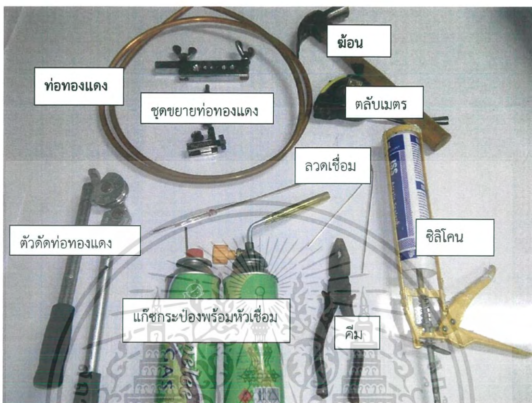
รูปที่ 3.4 อุปกรณ์ตัด ดัด เชื่อมต่อ ท่อระบายความร้อน
