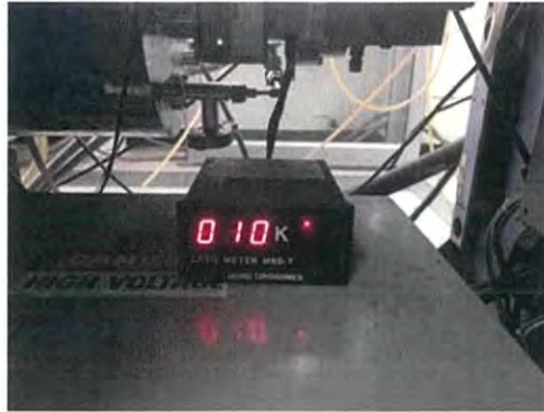
รูปที่ 3.7 ที่วัดอุณหภูมิของปั๊มโครโอเจนิคส์
