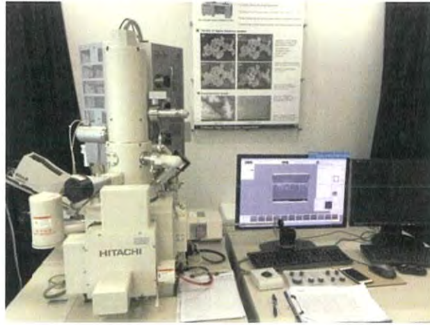
รูปที่ 3.11 กล้องจุลทรรศน์อิเล็กตรอนแบบส่องกราดติดตั้งที่อาคารกลุ่มนวัตกรรม 2 สำนักงานพัฒนาวิทยาศาสตร์และเทคโนโลยีแห่งชาติ (สวทช.)
