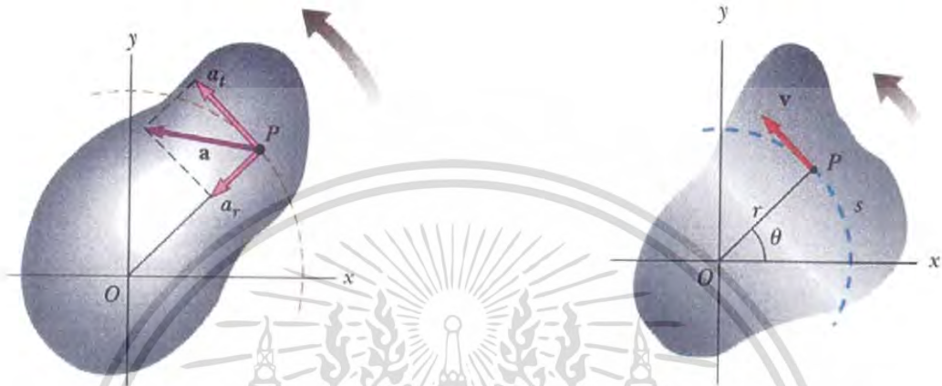
รูปที่ 2.6 แสดงความเร็วเชิงเส้นของวัตถุแข็งเกร็งแนวรัศมี
