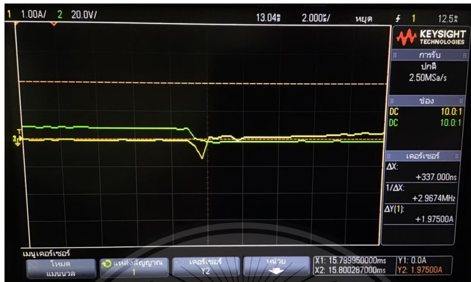
รูปที่ 4.54 ช่วงเวลา T_{ON} มีค่าเป็น 0 ของ MOSFET A High
