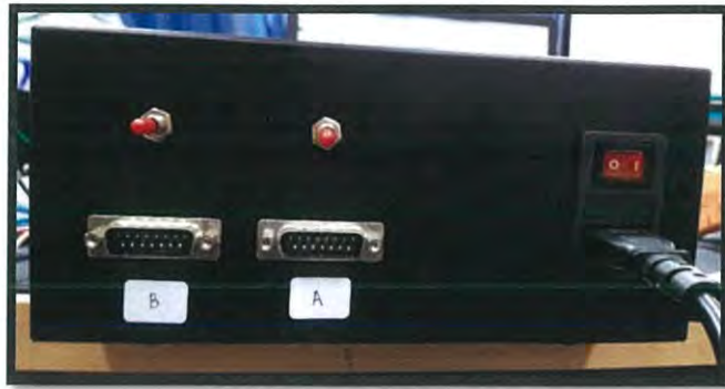
รูปที่ 3.15 ด้านหลังของเครื่องควบคุมอัตราการไหลของก๊าซ
