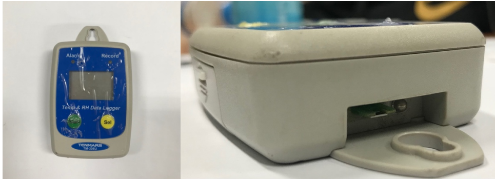
รูปที่ 3.2 เครื่องวัดอุณหภูมิและความชื้นรุ่น TENMARS TM-305U
