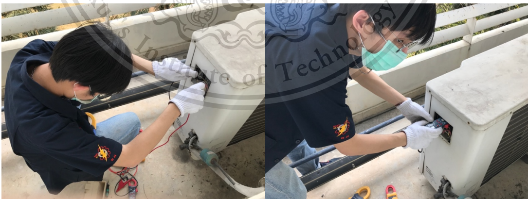
รูปภาพที่ 4.5 การวัดค่ากำลังไฟฟ้าที่ใช้โดยรวมของคอมเพรสเซอร์
