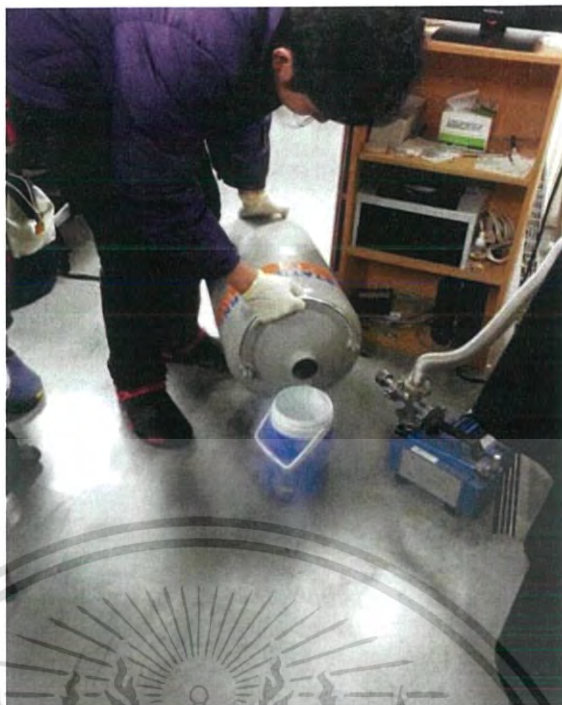
รูปที่ 3.33 แสดงการเตรียมไนโตรเจนเหลวเพื่อลดอุณหภูมิในภาชนะ
