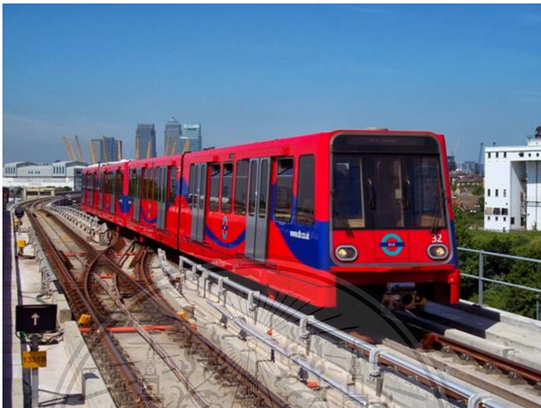
รูปที่ 2.7 รถไฟรางเบา Docklands พร้อมระบบไฟฟ้าสัมผัสด้านล่างของรางที่ 3 จะต้องมีช่องว่างในรางที่มีทางแยกหรือทางแยก
