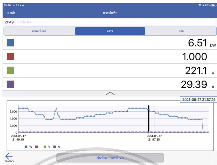
รูปที่ ค.7 การเก็บผลโดย Power Meter HIOKI .ในการทดสอบการส่งค่าขึ้นระบบฐานข้อมูลของอุปกรณ์ต้นแบบ ณ ตำแหน่งเวลาการวัดที่ 3
