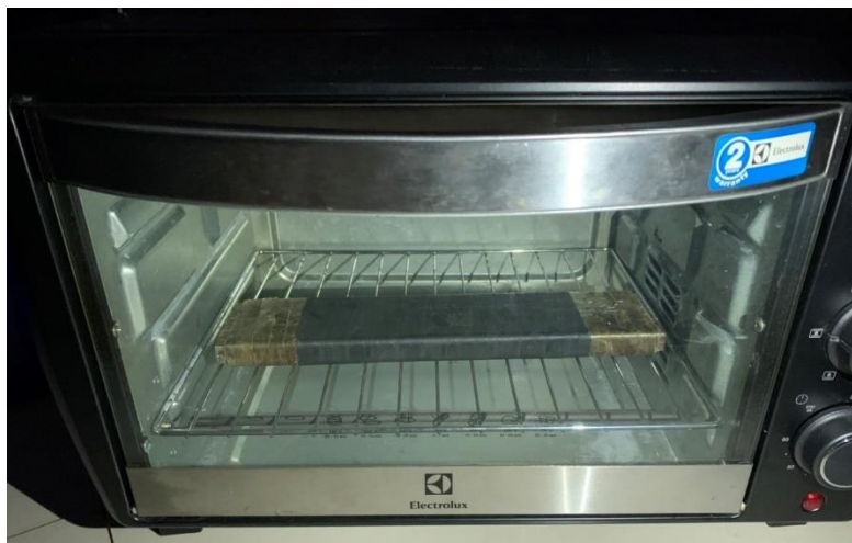
รูปที่ 3.5 ตู้อบที่ใช้ในการอบสเตเตอร์บาร์
