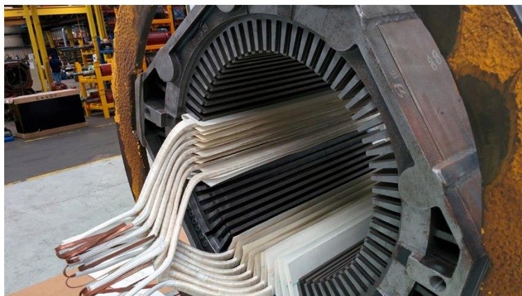
รูปที่ 2.4 ขดลวดสเตเตอร์แบบฟอร์มวาร์นแบบคอยล์ [3]
