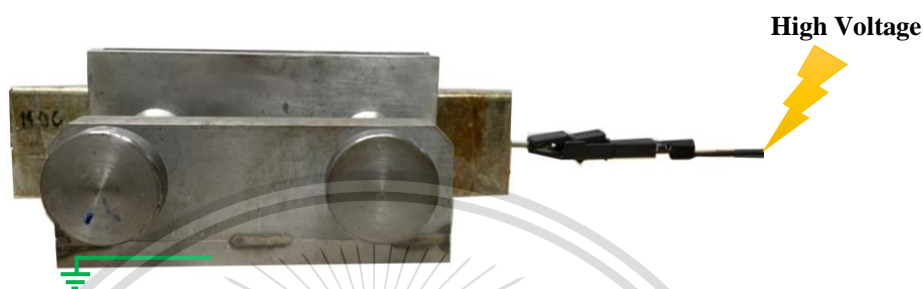
รูปที่ 3.23 การป้อนแรงดันให้กับสเตเตอร์บาร์ที่แทรกอยู่ในร่องสลิตที่ต่อลงกราวด์
