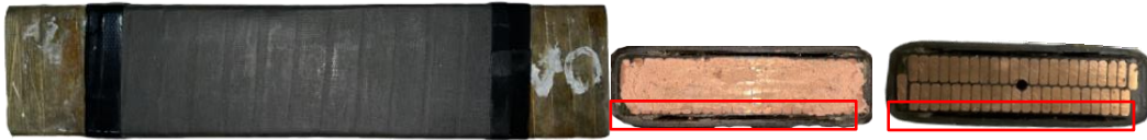
รูปที่ 3.11 วัตถุทดสอบที่ทำการจำลองกรณีที่ 8
