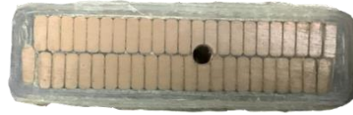
รูปที่ 3.20 สเตเตอร์บาร์ที่ถูกเจาะรูที่หน้าตัดตรงตัวนำของสเตเตอร์
