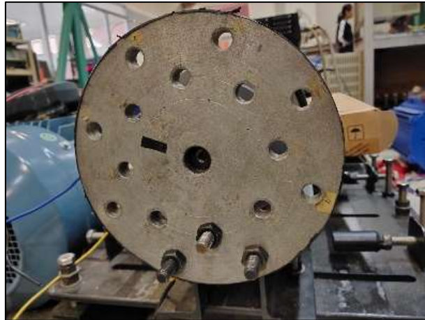
รูปที่ 3.7 มอเตอร์ที่สภาวะ Unbalance ทางกล
