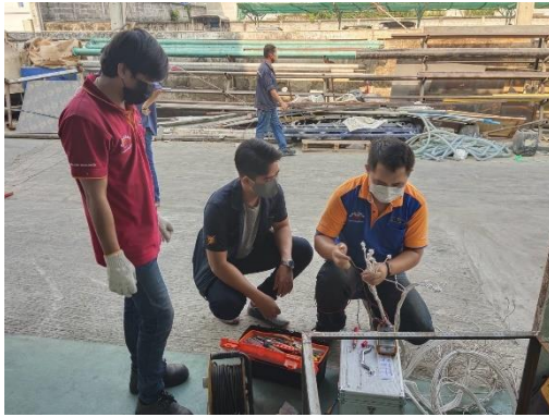
รูปที่ 4.2 ขณะทำการติดตั้ง Thermocouple
