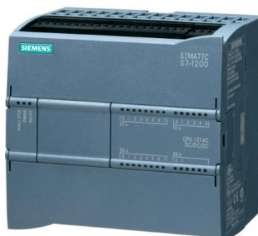
รูปที่ 3.13 หน่วยประมวลผล SIMATIC S7-1200 ของบริษัท Siemens
