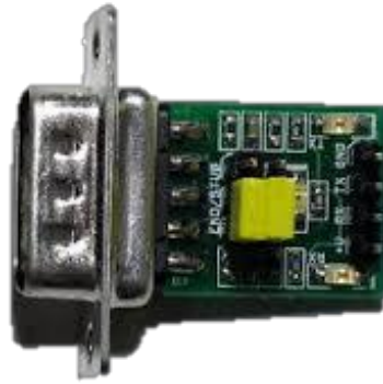
รูปที่ 3.8 วงจรแปลงการสื่อสารแบบ CAN เป็นสัญญาณ TTL
