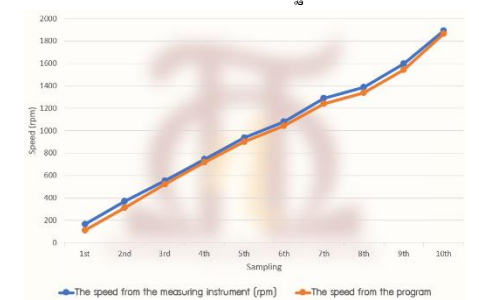
รูปที่ 4.6 กราฟแสดงการเปรียบเทียบความเร็วรอบของมอเตอร์ที่วัดจากค่าระบบกับเครื่องวัดมาตรฐาน
