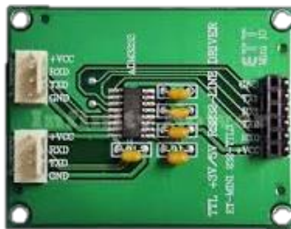
รูปที่ 3.10 วงจรแปลงสัญญาณ TTL เป็นการสื่อสารแบบ RS232
