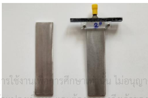
รูปที่ 3.3 ลักษณะของขั้วอิเล็กโทรดที่ถูกจ่ายไฟโดยวงจรไฟฟ้าขนาดใหญ่
