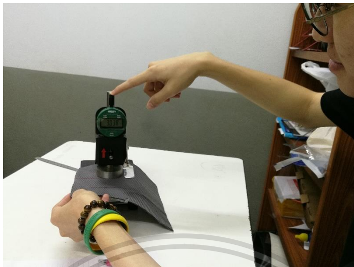
รูปที่ 3.13 การวัดความหนาของแผ่นยางพารารมควัน ชนิดที่ 3 หลังเคลือบสาร
