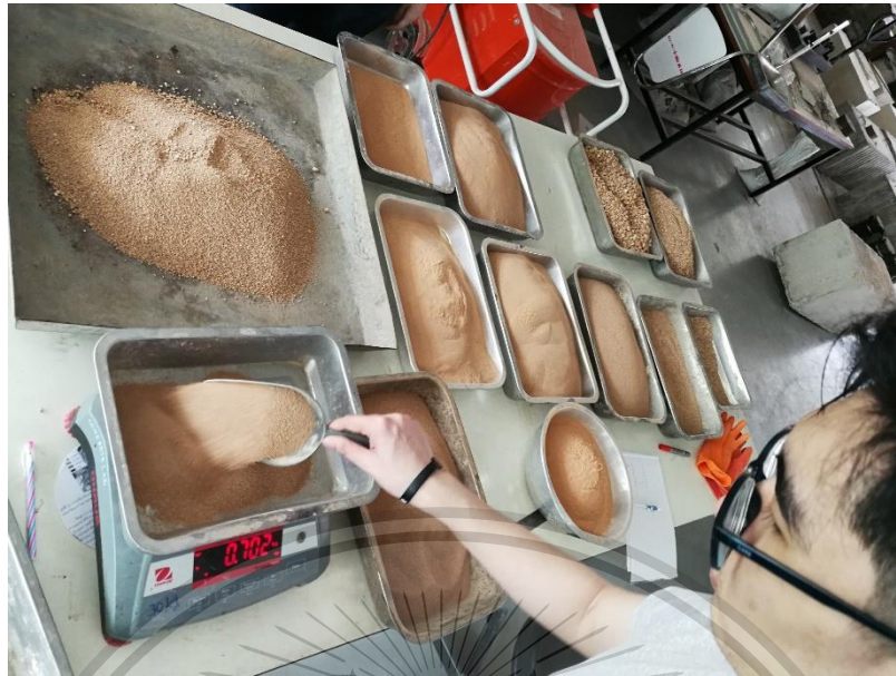
รูปที่ 3.24 การผสมตัวอย่างดินสำหรับการทดสอบการบดอัด
