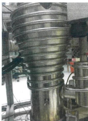
รูปที่ 3.2 (b) ปัมไอฟุ้งกระจายรุ่น Diffstak 160/700 ของบริษัท Edward
