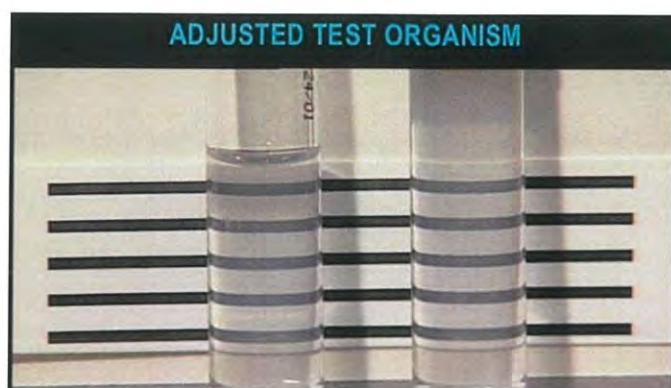
รูปที่ ค-1 แสดงการเทียบความขุ่นกับ McFarland standard
