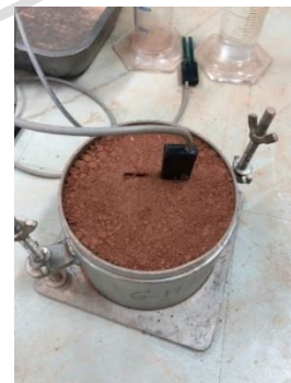
รูปที่ 3.2.1(ค) ขนาดเซนเซอร์moisture รูปที่ 3.2.1(ง) วิธีการคาลิเบต เซนเซอร์moisture
