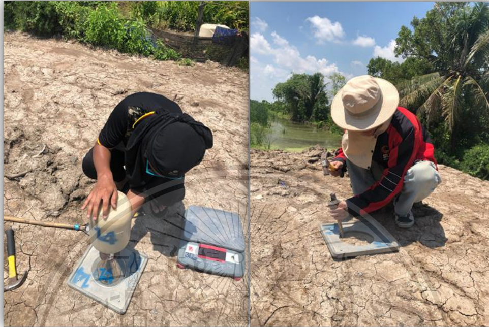
รูปที่ 3.1.2.1 Field Density Test โดยใช้ Sand Cone Method -ทดสอบ Atterberg Limit
