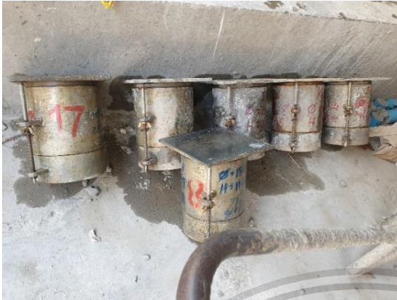
รูป 3.23 นำ C.B.R. Mold มาคว่ำปดอย ทิ้งไว้ 30 นาที
