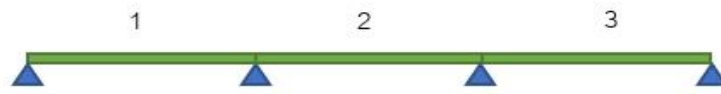
รูปที่ 4.76 สมมติฐานการวาง Live Load ที่ละ 3 Span
