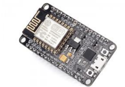
ภาพที่ 2.4 ตัวอย่างบอร์ดไมโครคอนโทรลเลอร์ NodeMCU
