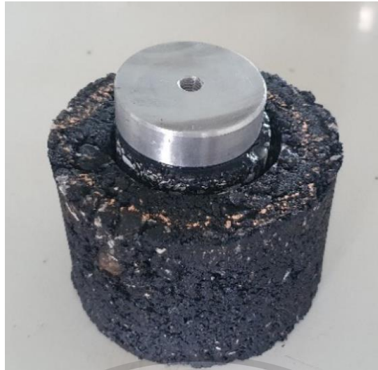
รูปที่ 3.10 การติดตัวอย่างมาร์แชลสองชุดเข้ากับตุ้กดตา
