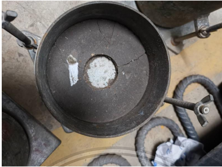
รูปที่ ค.11 แสดงการพืบัติของดินลูกรังประเภท E + เถ้าลอย 30 % + ปูนซีเมนต์ปอร์ตแลนด์ 5 % (บดอัด 25 ครั้ง)
