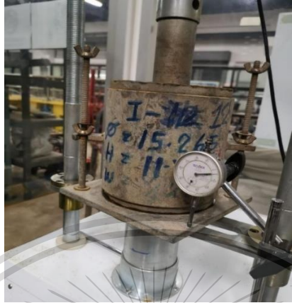
รูปที่ 3.20 แสดงการทดสอบการกดอัดตัวอย่างดิน
