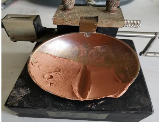
รูปที่ 3.6 แสดงการบดโดยเครื่องมือบดให้เป็นร่อนตรงกลาง
