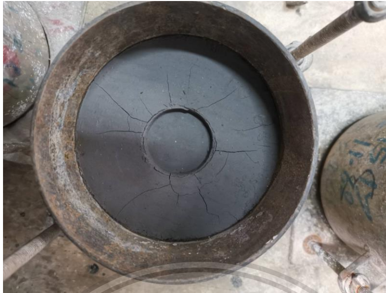
รูปที่ ค.15 แสดงการพืดของเถ้าลอย 100 % (บดอัด 56 ครั้ง)
