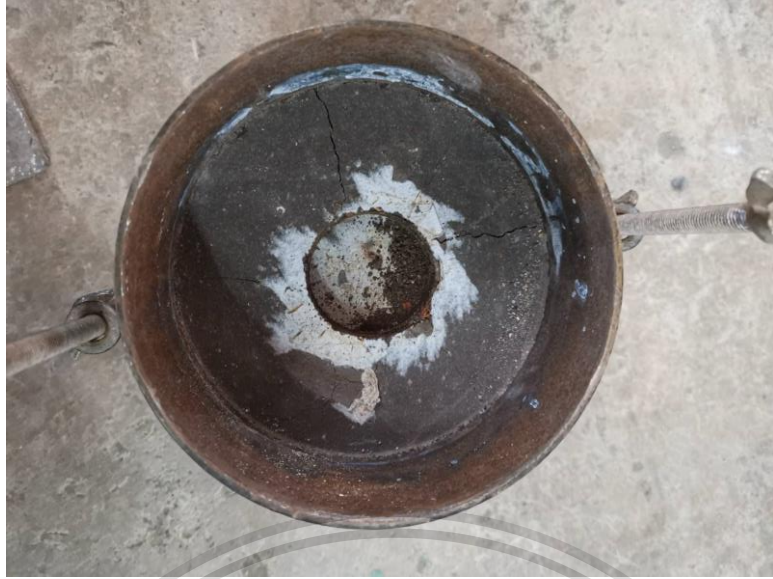
รูปที่ ค.9 แสดงการพืดของดินลูกรังประเภท E + เถ้าลอย 20 % + ปูนซีเมนต์ปอร์ตแลนด์ 5 % (บดอัด 56 ครั้ง)
