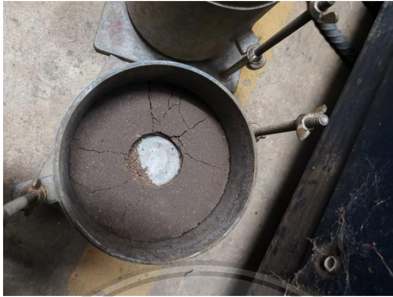
รูปที่ ค.7 แสดงการพืบัติของดินลูกรังประเภท E + เถ้าลอย 20 % + ปูนซีเมนต์ปอร์ตแลนด์ 5 % (บดอัด 12 ครั้ง)
