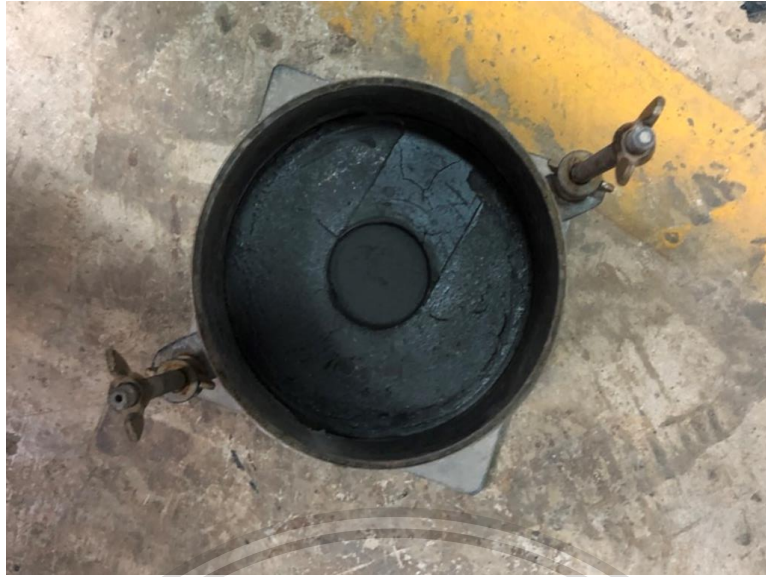
รูปที่ ค.13 แสดงการพืดของเถ้าลอย 100 % (บดอัด 12 ครั้ง)
