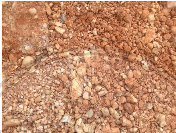
รูปที่ 2.4 ลักษณะของดินลูกรังที่ใช้ในงานก่อสร้างถนน
