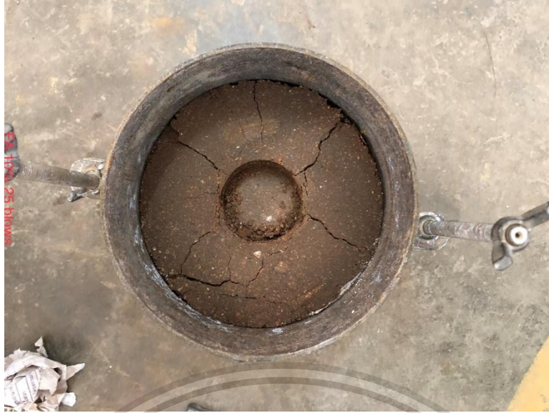
รูปที่ ค.5 แสดงการพืบัติของดินลูกรังประเภท E + เถ้าลอย 10 % + ปูนซีเมนต์ปอร์ตแลนด์ 5 % (บดอัด 25 ครั้ง)
