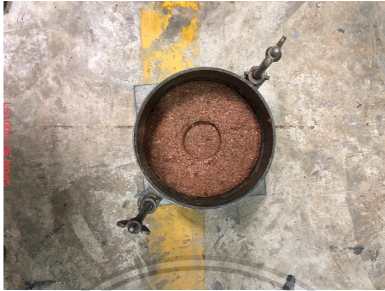
รูปที่ ค.3 แสดงการพิบัติของดินลูกรังประเภท E (บดอัด 56 ครั้ง)
