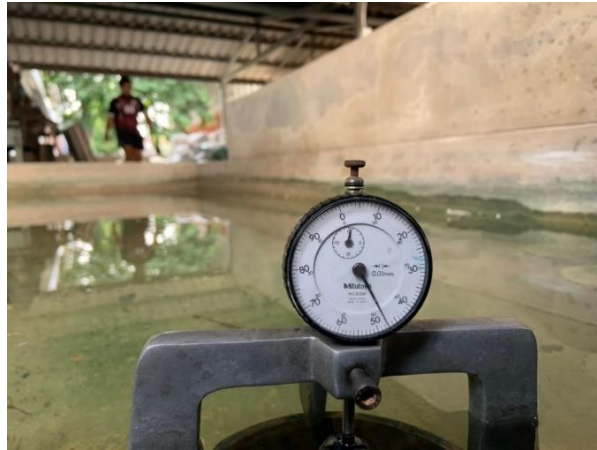
รูปที่ 3.23 แสดงการวัดค่าบวมตัวของตัวอย่างดิน
