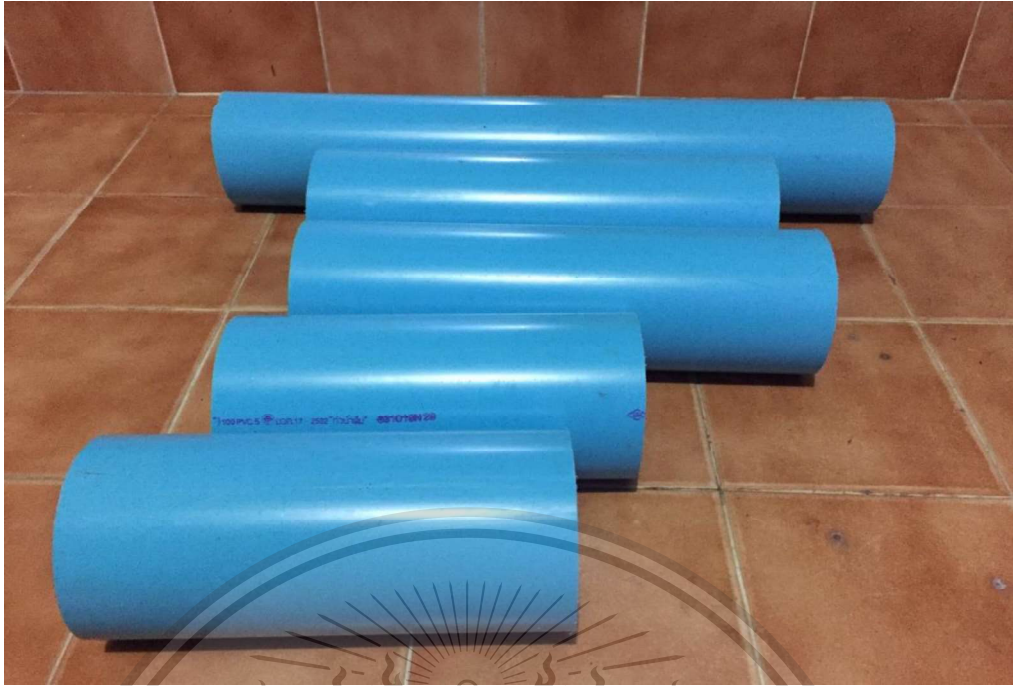
รูปที่ 3.11 วัดขนาดและตัดท่อพีวีซีตามขนาดที่ระบุในแบบ
