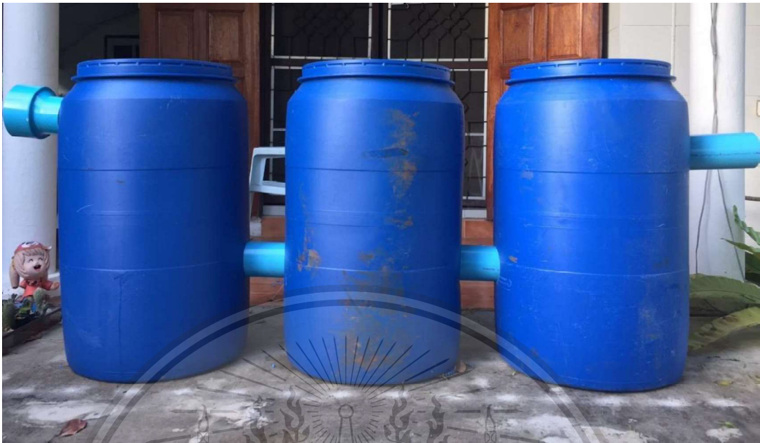
รูปที่ 4.1 ชิ้นงานถึงดักไขมันที่เสร็จสมบูรณ์
