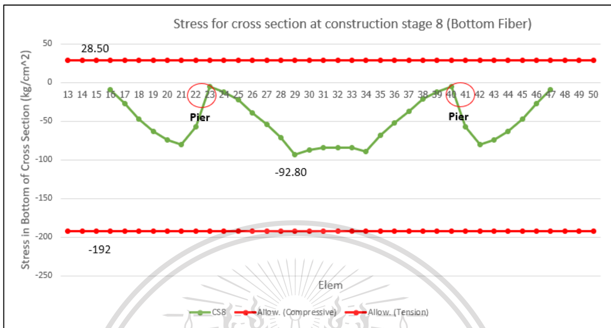
รูปที่ 4.1-7 หน่วยแรงที่เกิดขึ้นที่ผิวล่างของคอนกรีตในขั้นตอนการก่อสร้างขั้นตอนที่ 8 เทียบกับหน่วยแรงขีดจำกัดของโครงสร้าง
