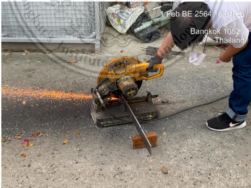
รูปที่ 3.3-2 การตัดเหล็กด้วยไฟเบอร์ให้ได้ความยาว 250 มิลลิเมตร
