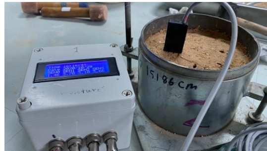
รูปที่ 3.8 วิธีการคาลิเบต moisture sensor
