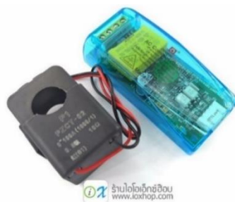
รูปที่ 2.10 โมดูลวัดพลังงาน
