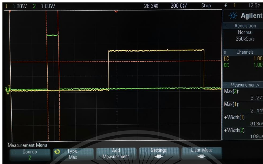
ภาพที่ 4.8 ผลการวัด pulse จากขา Echo และ ขา Trigger ของเซนเซอร์วัดระยะทางแบบ Ultrasonic ที่ระยะห่าง 15 cm จากเซนเซอร์ถึงสิ่งกีดขวาง
