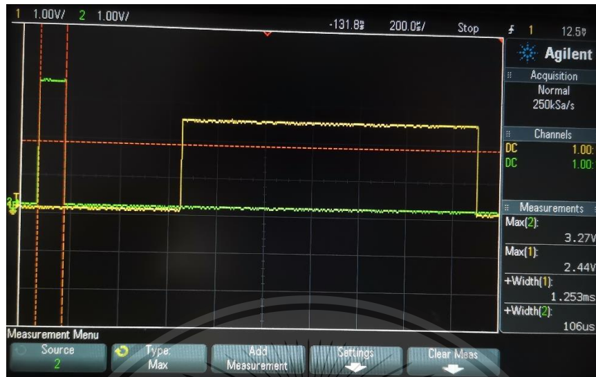
ภาพที่ 4.12 ผลการวัด pulse จากขา Echo และ ขา Trigger ของเซนเซอร์วัดระยะทางแบบ Ultrasonic ที่ระยะห่าง 22 cm จากเซนเซอร์ถึงสิ่งกีดขวาง
