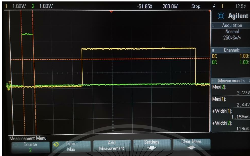
ภาพที่ 4.10 ผลการวัด pulse จากขา Echo และ ขา Trigger ของเซนเซอร์วัดระยะทางแบบ Ultrasonic ที่ระยะห่าง 20 cm จากเซนเซอร์ถึงสิ่งกีดขวาง
