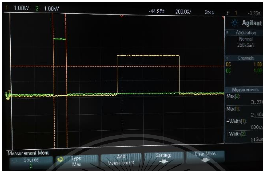
ภาพที่ 4.6 ผลการวัด pulse จากขา Echo และ ขา Trigger ของเซนเซอร์วัดระยะทางแบบ Ultrasonic ที่ระยะห่าง 10 cm จากเซนเซอร์ถึงสิ่งกีดขวาง
