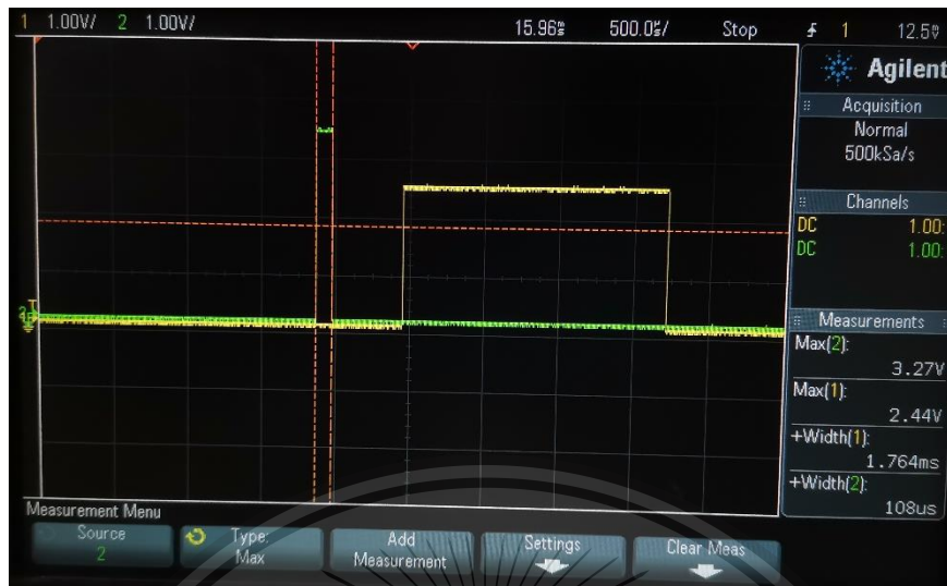
ภาพที่ 4.16 ผลการวัด pulse จากขา Echo และ ขา Trigger ของเซนเซอร์วัดระยะทางแบบ Ultrasonic ที่ระยะห่าง 30 cm จากเซนเซอร์ถึงสิ่งกีดขวาง จากผลการทดลองจึงนำมาสรุปดังตารางแสดงในตารางที่ 4.2 โดยคำนวณระยะห่างได้จากสมการที่ 4.1 ดังนี้
