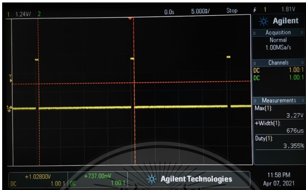
ภาพที่ 4.19 ผลการวัด pulse จากขา output ของเซอร์โวมอเตอร์ที่ค่าเซอร์โวมอเตอร์ 3.0 (มุม -15 องศา)
