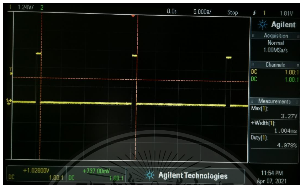
ภาพที่ 4.21 ผลการวัด pulse จากขา output ของเซอร์โวมอเตอร์ที่ค่าเซอร์โวมอเตอร์ 4.6 (มุม 15 องศา)
