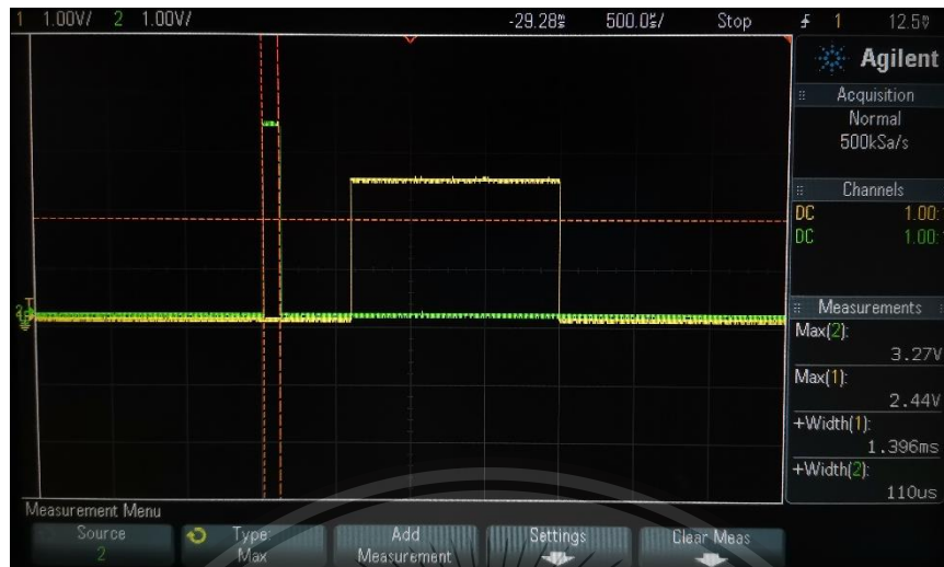
ภาพที่ 4.14 ผลการวัด pulse จากขา Echo และ ขา Trigger ของเซนเซอร์วัดระยะทางแบบ Ultrasonic ที่ระยะห่าง 24 cm จากเซนเซอร์ถึงสิ่งกีดขวาง
