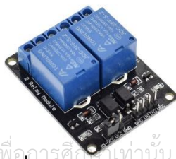
รูปที่ 2.10 Relay module
