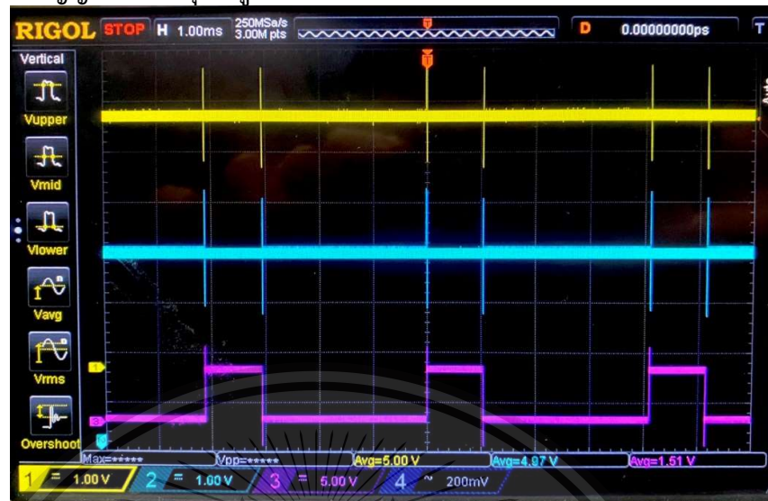
รูปที่ 4.10 สัญญาณพัลส์ที่ขับ LED RGB
