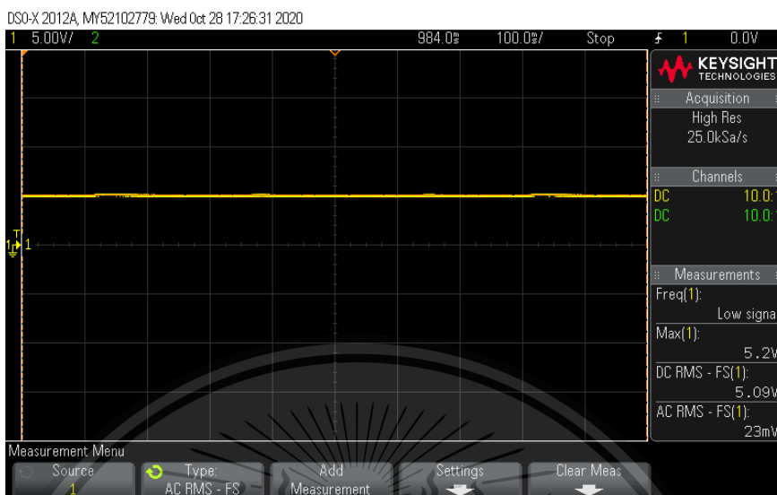
รูปที่ 4.6 แรงดันตกคร่อมตัวเก็บประจุ
