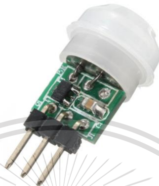
รูปที่ 2.3 AM312 PIR Motion Sensor
