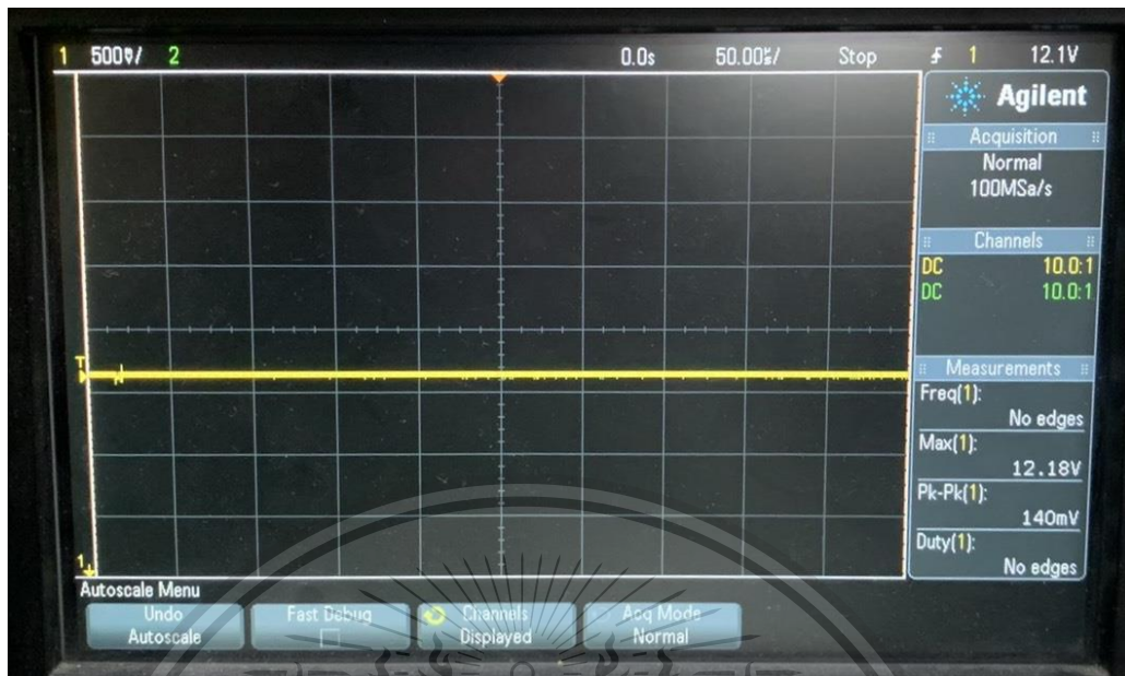
รูปที่ 4.3 : Output 5v ของ LM7805 ที่มีโหลดภาระ
