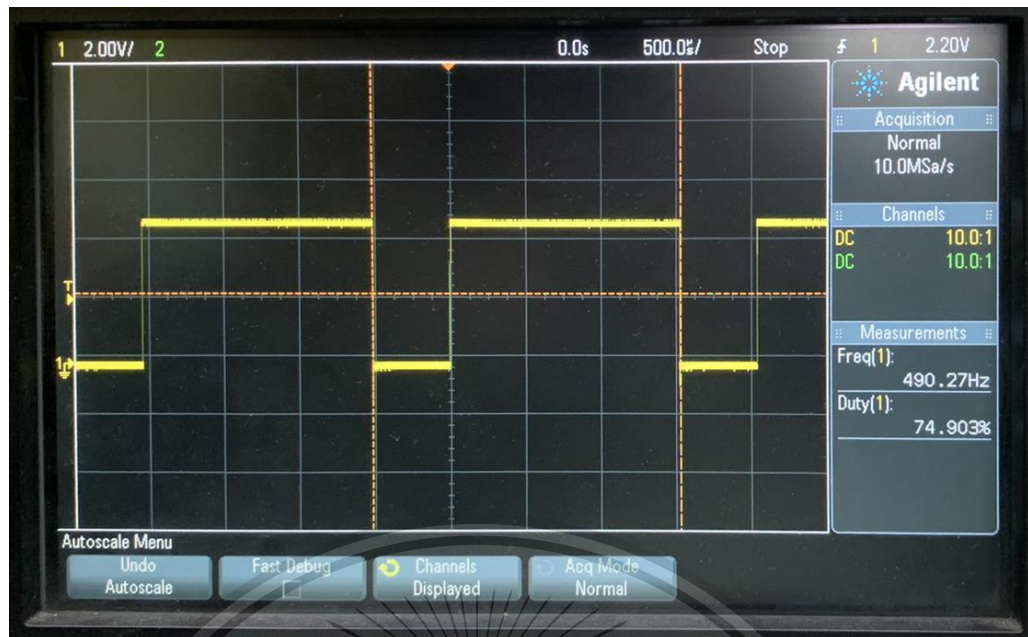
รูปที่ 4.7 : Duty Cycle 75% ของ Motor Drive
