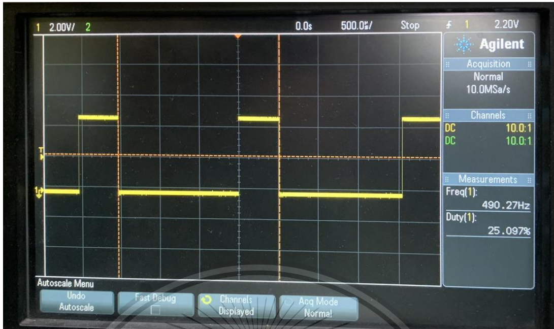
รูปที่ 4.9 : Duty Cycle 25% ของ Motor Drive
