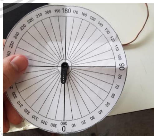
รูปที่ 4.12 ผลการทดลองที่ 0 องศา ค่า Duty cycle 2.8%
