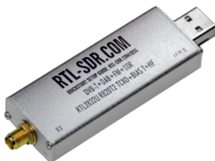
รูปที่ 3.29 อุปกรณ์ RTL-SDR รุ่น RTL2832U (ที่มา: https://bit.ly/3dqAjnQ )
