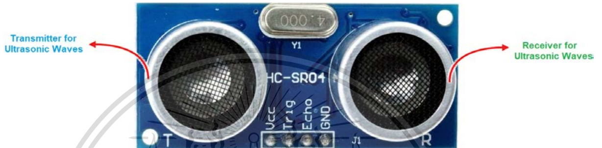
รูปที่ 2.16 ตัวรับ และตัวส่งคลื่น Ultrasonic บนโมดูล
