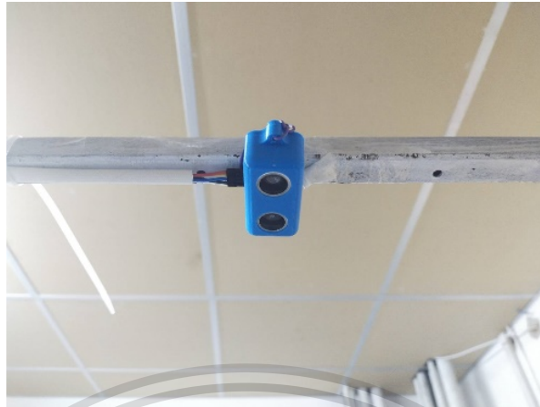
รูปที่ 4.11 เซนเซอร์ HC-SR04 ที่ติดตั้งอยู่บนโครงของเครื่องวัด
